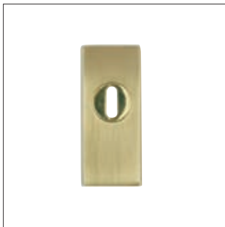
PZ-Sicherheitsrosette Messing brüniert, bedingt wetterbeständig mit Kernziehschutz B 30 mm x H 70 mm, Stärke 10 mm
