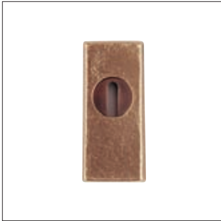
PZ-Sicherheitsrosette, Bronzeguss Art.-Nr. 1063 mit Kernziehschutz B 30 mm x H 65 mm, Stärke 10 mm
