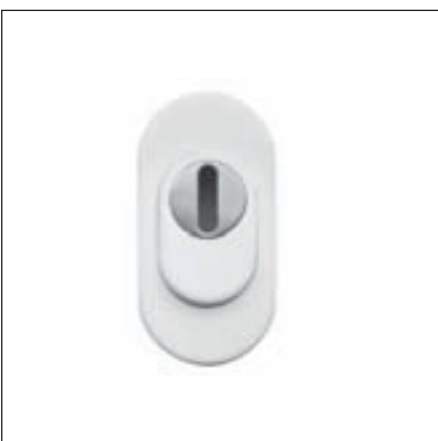
PZ-Sicherheitsrosette, weiß mit Kernziehschutz, einstellbar von 8 - 15 mm B 37 mm x H 74 mm, Stärke 14 mm
